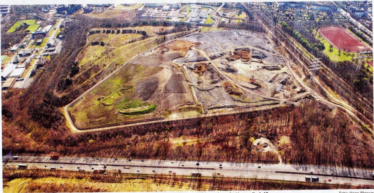
Die Thyssen-Halde in Wanne. Seit Ende 2010 ruht die Aufschüttung der ehemaligen Gichtgasschlammdeponie. Vorne: die A 42.
